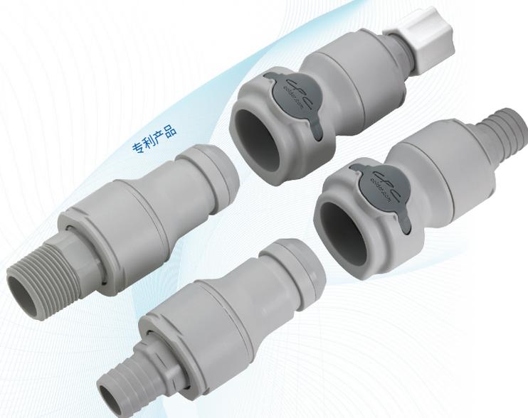
**NSH 系列接头**是我司 ChemQuik® CQG06 系列的通用版本，具有防溢漏，压力均衡的设计。模制聚丙烯及 EPDM 密封件，不含金属配件，无弹簧的畅顺通道，抗化学能力强，令液体能以最大流量高速传输。即使在加压情况下也能即时断开（复接）。无溢漏设计，彻底消除了溢漏隐患，有效地缩短了停机时间，提高了操作人员的安全性，成本非常低。
